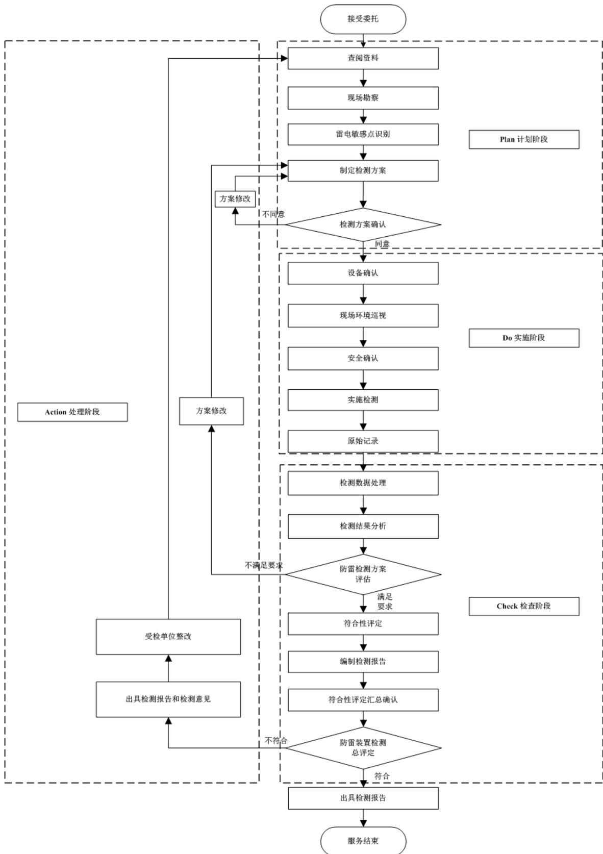
图1 图 1 防雷装置检测服务通用流程图
